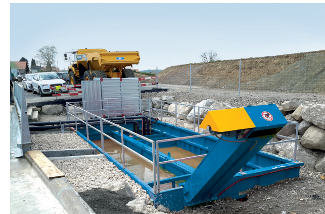
Recyclingtank 50 mit Kratzförderer und Recyclingtank 50 Recycling tank 50 with scraper conveyor and recycling tank 50
