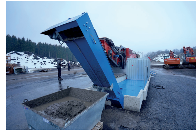
Recyclingtank 50 mit Kratzförderer Recycling tank 50 with scraper conveyor
