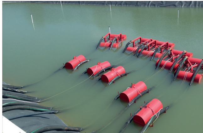
Becken mit MobyDick Pumpen und Pontons Ponds with MobyDick pumps and pontoons
